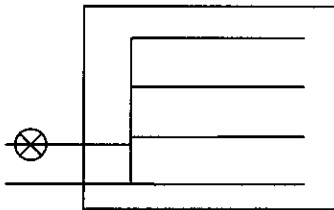
43: Toma(s) con y sin medidor con ramificaciones sin medidor con cuenta asignada.
